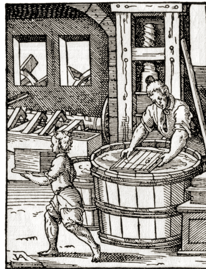
Papperstillverkning av lump och linnefibrer.
